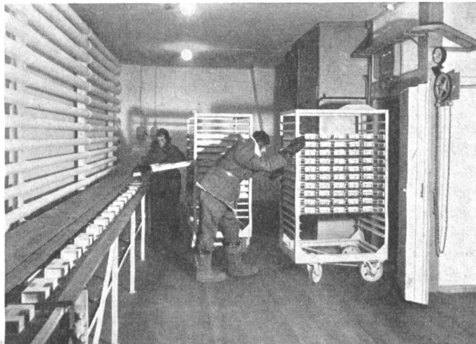
Bild 1 oben: Transportable Gefrieranlage, welche zur Erntezeit in die Anbaugelände fährt, um die frisch gewonnenen Früchte oder Gemüse an Ort und Stelle zu konservieren. (Aufnahme Birds Eye, Zürich)
