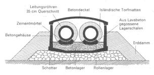
Bild 3: Querschnitt durch den Erddamm mit dem Betonkanal, der die Doppelleitung enthält.
