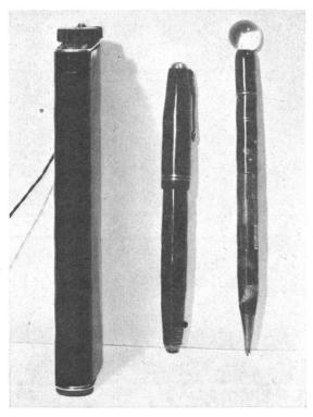
Bild 1: Dieser winzige Fünfröhren-Empfänger ist kaum länger als eine Füllfeder. Er wiegt einschließlich der Batterien nur 280 Gramm. – Für den Empfang steckt man einen Kristallhörer von Erbsengröße ins Ohr.
