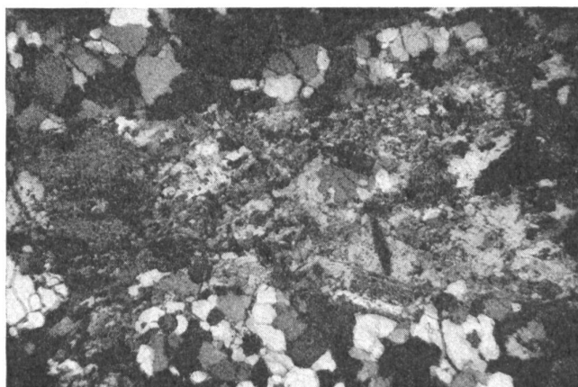
Mikrophotographie eines Dünnschliffes vom Granit des Monte Prosa, anstehend auf der Paßhöhe des St. Gotthards, östlich der Straße. Aufnahme unter gekreuzten Nicols bei zwölfacher Vergrößerung.
