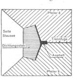
Bild 8: Dichtungsstäbe zwischen zwei unabhängigen Pfeilern
