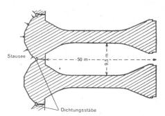
Bild 7: Grundriß von zwei Pfeilern der Lucendrosperre
