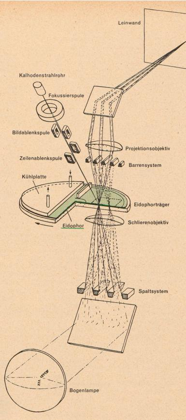
Bild 5: Grundsätzlicher Aufbau des A.f.i.F. Fernseh-Großprojektors.
