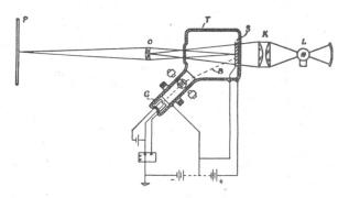
Bild 3: Prinzipschema einer Skiatron-Röhre der Scophony-Gesellschaft. L Lichtquelle, K Kondensorlinse, O Projektionsobjektiv, P Projektionsschirm, S Kristallschirm, G Kathodenstrahlrohr, B Kathodenstrahl.
