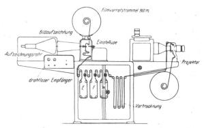
Bild 1: Prinzipielle Anordnung des Zwischenfilm-Großprojektionsverfahrens.
