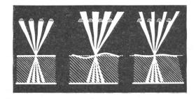
Bild 7: Lichtsteuerung bei der Schlierenoptik.
