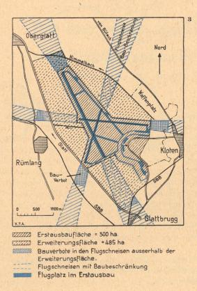
Bild 3 links: Die Flächen, die der Flugplatz Kloten beim Erstausbau beansprucht samt denjenigen, die für die Erweiterung reserviert sind. Die Pisten des Erstausbaues sind blau eingetragen, die Flugschneisen blau gerastert.
