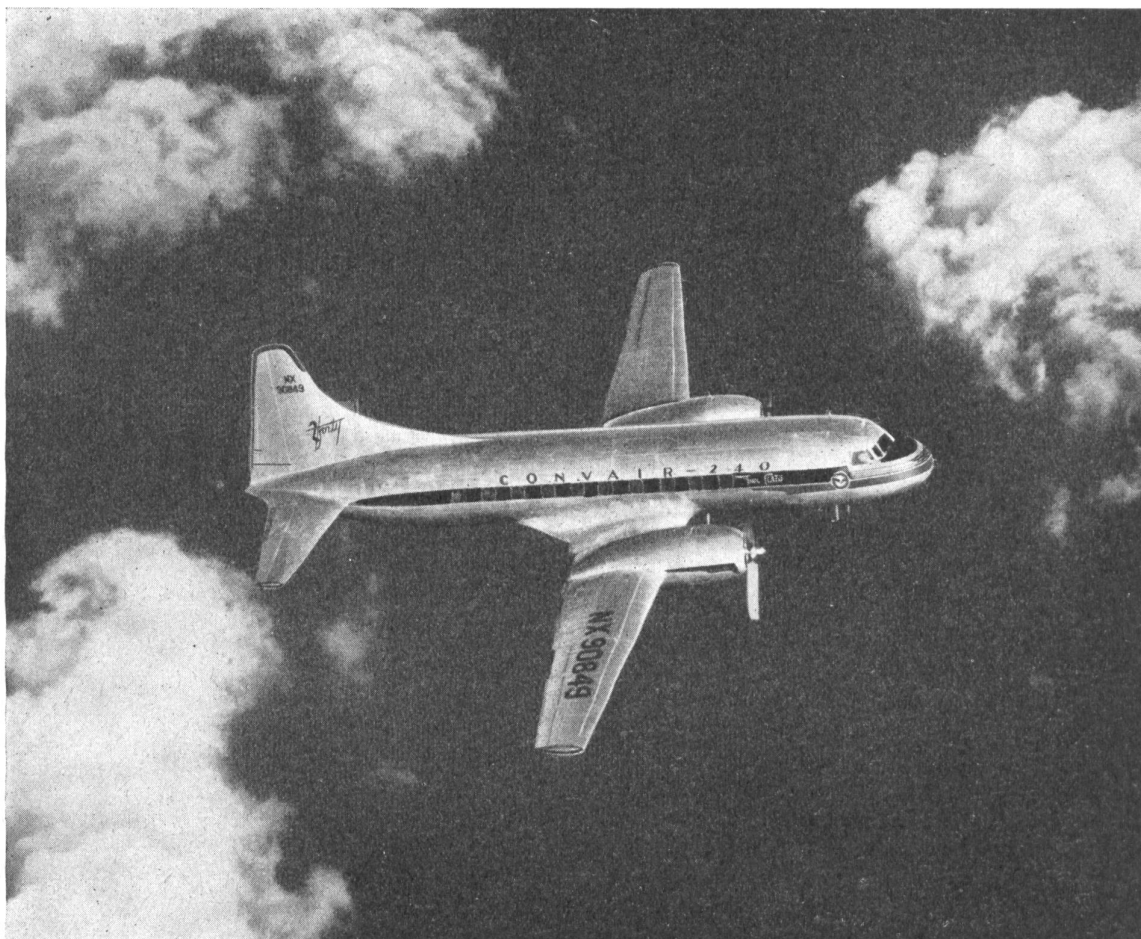
Bild 1: Der amerikanische 40plätzig «Convair-Liner» ist eines der modernsten Mittelstreckenflugzeuge; er steht seit Anfang 1948 in Betrieb. Die Swissair wird in nächster Zeit vier Stück dieser Type erhalten. Das Abfluggewicht des Flugzeugs beträgt 17,9 Tonnen, seine Spannweite 28 m. Die beiden Motoren entwickeln eine maximale Startleistung von je 2400 PS.
