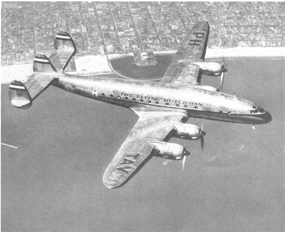
Bild 3: Seit Kriegsende ist auf vielen Kontinental- und Überseestrecken die amerikanische Lockheed «Constellation» in Betrieb, die durch ihren fischförmigen Rumpf und das dreifache Leitwerk auffällt. Dieses Flugzeug befördert je nach Streckenlänge 44 bis 52 Passagiere; sein maximales Fluggewicht beträgt 56,6 Tonnen, seine Spannweite 37,5 Meter. Die vier Motoren entwickeln eine maximale Startleistung von je 2400 PS.
