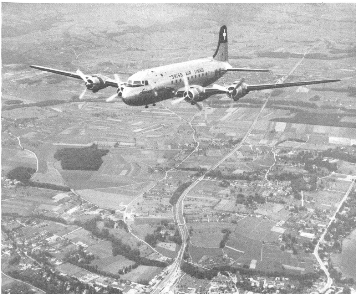
Bild 4: Douglas DC-4, das in großer Zahl verwendete viermotorige Langstreckenflugzeug für 44 Passagiere, das auch bei der Swissair besonders für Überseeflüge in Dienst steht. Sein maximales Fluggewicht beträgt 33,8 Tonnen, die Spannweite 35,8 Meter. Startleistung pro Motor 1450 PS.
