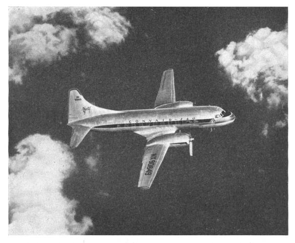
Bild 1: Der amerikanische 40plätzige «Convair-Liner» ist eines der modernsten Mittelstreckenflugzeuge; er steht seit Anfang 1948 in Betrieb. Die Swissair wird in nächster Zeit vier Stück dieser Type erhalten. Das Abfluggewicht des Flugzeugs beträgt 17,9 Tonnen, seine Spannweite 28 m. Die beiden Motoren entwickeln eine maximale Startleistung von je 2400 PS.
