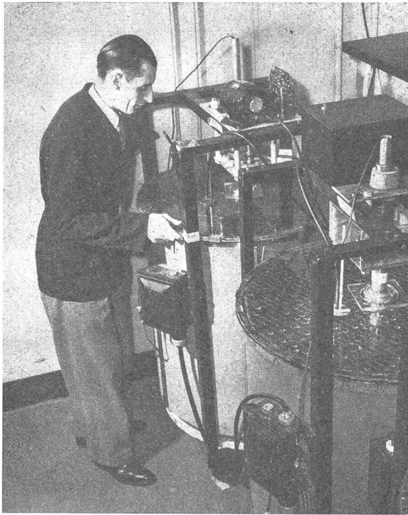
Bild 7: Das neue Kristallzuchtverfahren der Bell-Telephone Laboratories.
