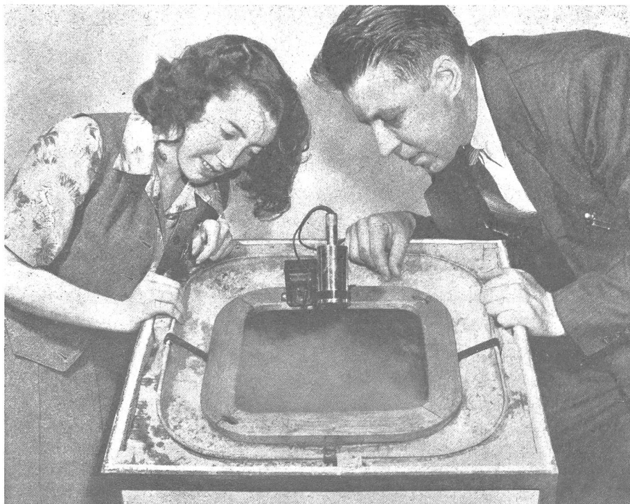
Bild 1: Jedermann kann, wenn er will, seinen eigenen kleinen Schneesturm erzeugen. Dieses Bild zeigt den Erfinder des Verfahrens, Vincent J. Schaefer, mit einem amerikanischen Schulmädchen, das sich für diesen Zweck selbst eine Kühlkammer gebaut hat. Kostenpunkt: rund 18 Franken. Die Kammer besteht im wesentlichen aus zwei ineinander passenden Waschgefäßen. Die Zwischenräume sind mit einem Eis-Salz-Gemisch gefüllt, das den Raum in der kleineren Schüssel abkühlt. Durch Atmen in das Gefäß wird eine unterkühlte Wolke erzeugt, in der dann durch ein paar Körnchen Trockeneis Schnee gebildet wird.
