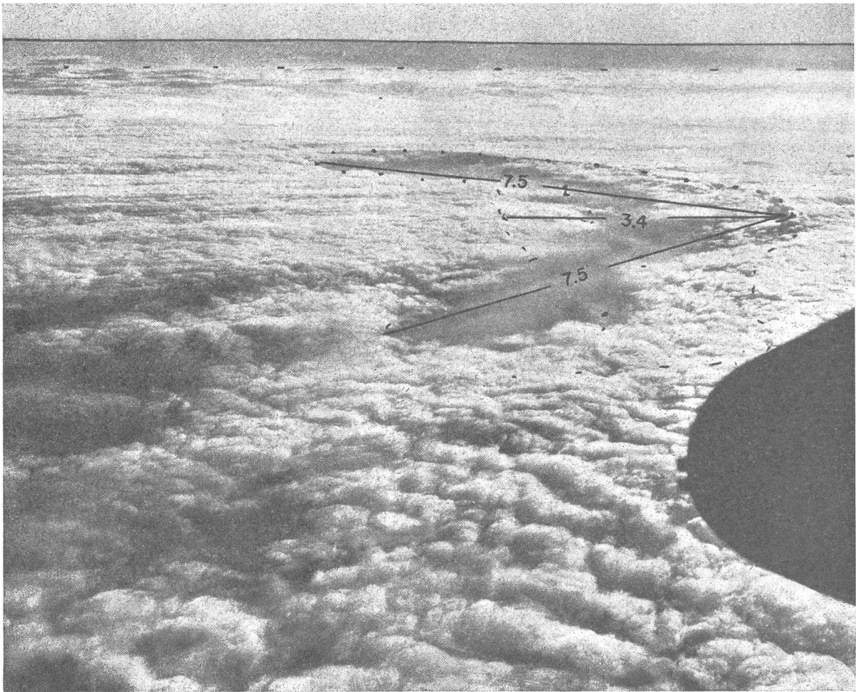
Bild 2: Durch «Besäen» einer Wolkenschicht mit Trockeneis wird der Wasserdampf zum Kristallisieren gebracht, so daß ein 24 Kilometer langes, 5 Kilometer breites L-förmiges Loch in der Wolkendecke geschaffen wird. Innerhalb eines solchen Loches kann ein Flugzeug aufsteigen und landen, ohne der Gefahr der Vereisung ausgesetzt zu sein. (Die angedeuteten Abmessungen sind in Meilen angegeben, eine Meile = 1,6 Kilometer.)
