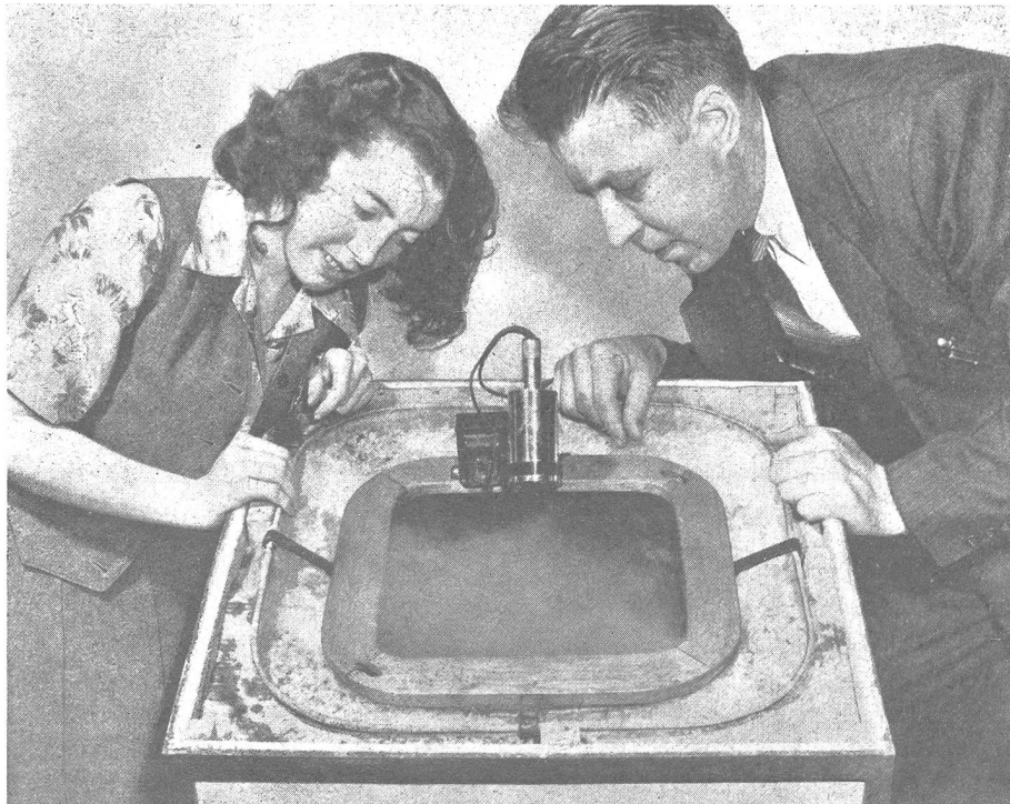
Bild 1: Jedermann kann, wenn er will, seinen eigenen kleinen Schneesturm erzeugen. Dieses Bild zeigt den Erfinder des Verfahrens, Vincent J. Schaefer, mit einem amerikanischen Schulmädchen, das sich für diesen Zweck selbst eine Kühlkammer gebaut hat. Kostenpunkt: rund 18 Franken. Die Kammer besteht im wesentlichen aus zwei ineinander passenden Waschgefäßen. Die Zwischenräume sind mit einem Eis-Salz-Gemisch gefüllt, das den Raum in der kleineren Schüssel abkühlt. Durch Atmen in das Gefäß wird eine unterkühlte Wolke erzeugt, in der dann durch ein paar Körnchen Trockeneis Schnee gebildet wird.
