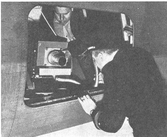
Bild 36: Montage einer Fernsehkamera im Rumpf eines Flugzeugs. Fernsehanlagen in bemannten oder ferngelenkten Flugzeugen gestatten den am Boden oder in der Luft befindlichen Empfangsstellen die Beobachtung des vom Flugzeug überflogenen Gebietes.
