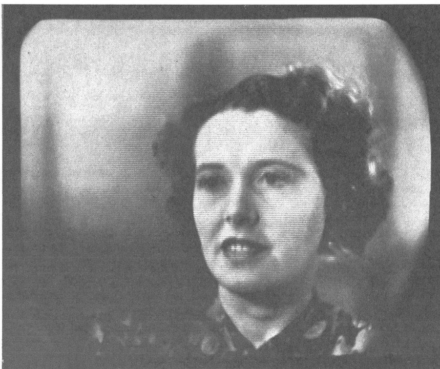
Bild 27: Porträts und Großaufnahmen werden im Fernsehempfangsgerät gut wiedergegeben. Bildzerlegung in 405 Zeilen. (BBC)
