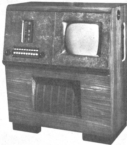
Bild 25: Englischer Fernsehempfangsapparat in Schrankform mit einer Televisionröhre von 30 cm Durchmesser. Der Apparat gestattet außerdem den Empfang von Lang-, Mittel- und Kurzwellenstationen.
