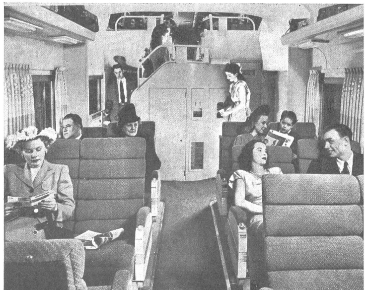
Bild 2: Blick in das Innere eines der neuen zweistöckigen amerikanischen Wagen. Denkbar bequeme, gepolsterte Sessel, individuelle Beleuchtung für jeden Sitz, hochgelegene und unauffällige Gepäckborte und schließlich das völlige Fehlen von Zwischenwänden, Stützen und Streben, dies alles trägt dazu bei, daß der Reisende denkbar gut untergebracht ist und jedes Gefühl der Beengtheit verliert, das ihn bei einer langen Eisenbahnfahrt leicht befällt.
