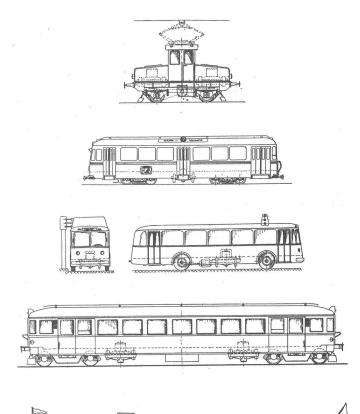
Bild 2: Anwendungsbeispiele für den Elektrogyro-Antrieb (von oben nach unten): Rangierlokomotive, Tram, Omnibus (das linke Bild zeigt die Stromabnahme an einer Haltestelle), Eisenbahn-Personenwagen, Personenschiff.
