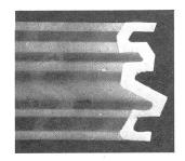
Bild 6: Schematische Darstellung zur Erklärung der hellen und dunklen Ringe des Blitzbandes (vergleiche Bild 3). Eine künstlich hergestellte «Blitzspur» wurde über einen lichtempfindlichen Film gezogen. Dabei zeigt sich deutlich, daß die Ziehspur dort dunkel ist, wo die «Blitzspur» quer zur Zugrichtung verläuft und daß die Spur dort heller ist, wo sie in der Zugrichtung verläuft.
