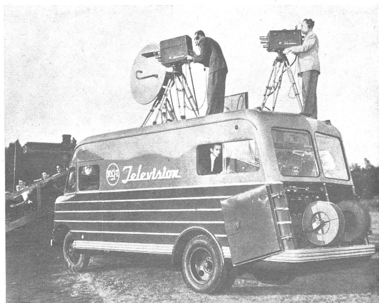
Bild 11: Die fahrbare Senderkolonne der British Broadcasting Corporation. Hinten der Antennenwagen, in der Mitte der Senderwagen, vorne der Kamerawagen, links ist außerdem ein Teil des Generatorwagens zu erkennen.
