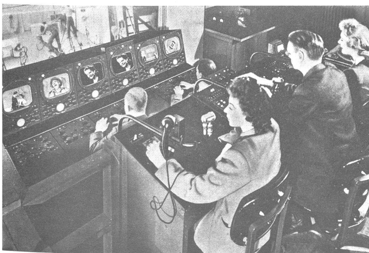
Bild 10: Im Kontrollraum einer großen Fernsehstation in New York verfolgt der Produktionsleiter mit seinen Hilfskräften den Ablauf der Sendung. Er sitzt in der Mitte am erhöhten Kommandopult und erteilt telephonisch seine Weisungen ins Studio, in das er durch ein Fenster Einblick hat. Rechts von ihm sitzt die Bildmischerin zur Einschaltung der verschiedenen Kameras und Filmeinlagen, links am Kommandopult regelt die Tonmischerin die Mikrophone und Schallplattenbegleitung. Am zweiten Pult, unmittelbar bei den Fernsehschirmen, sind noch zwei Operateure mit der Überwachung der Bildqualität beschäftigt. – Die Fernsehschirme zeigen das soeben gesendete Bild und andere Szenen, die jederzeit vom Bildmischer eingeschaltet werden können, sowie das Signet des Senders und eine für die richtige Einstellung der Empfangsgeräte in den Zwischenpausen gesendete Test-Zeichnung.
