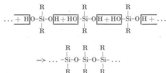
Die Silikone bestehen also aus einem Gerüst von Silizium- und Sauerstoffatomen, während die Seitenvalenzen der Si-Atome durch Kohlenwasserstoffreste besetzt sind. Diese Kettenstruktur, wo Silizium- und Sauerstoffatome abwechseln
