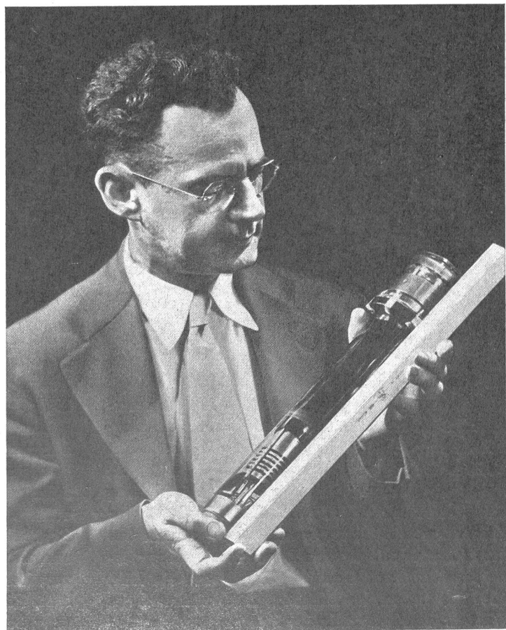
Bild 6 oben: Das Bild-Orthikon (Image Orthicon). Das Linsenobjektiv L wirft das Bild des Gegenstandes O auf die lichtempfindlich gemachte Innenseite P des Glaskolbens, die mit einem Mosaik aus winzigen Photozellen überzogen ist. Von diesen Mosaikkörnchen werden, proportional zur Lichtintensität, Elektronen ausgestoßen, die in parallelen Bahnen gegen die Zielplatte Z fliegen. Auf deren Vorderseite lösen sie zahlreiche Sekundärelektronen aus, wodurch auf der Rückseite der Zielplatte ein positives «Spannungsbild» entsteht. Dieses wird mit dem Elektronenstrahl T – der von der Kathode K ausgeht – abgetastet, wobei so viele Elektronen abgesetzt werden, daß die positive Ladung auf der Zielplatte neutralisiert wird. Der auf diese Weise modulierte Rest des Elektronenstrahles R wird in die Richtung der Kathode K zurückgeführt, dort in einem Elektronenvervielfacher verstärkt und ergibt damit ein Ausgangs-Signal, das weiteren Verstärkern und dem Sender zugeführt wird. (Die zur Steuerung des Elektronenstrahles dienenden Spulen sind nicht eingezeichnet).
