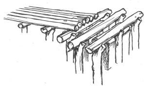
Bild 2: Bau eines Dolmengrabes auf der Insel Sumba (Indonesien). Bereits stehen die Stützsteine der Grabkammer, es fehlt noch die Deckplatte. Aus starken Stämmen ist eine sanft geneigte Rampe auf gebaut worden, die es erlaubt, den schweren Riesenstein in die richtige Lage über die Stützsteine zu bringen. Dann werden die Baumstämme entfernt und die Grabkammer ist fertig. (Nach Originalphoto von G. Schröder, gezeichnet von Gunther Schärer)
