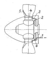
Bild 9: Propellerenteisungsanlage für Alkohol-Glyzerin Mischung. 1 Zuführung der Enteisungsflüssigkeit. 2 Schleuderring 3 Verbindungsrohr. 4 Umführungslasche an der Blattwurzel. 5 Austrittsrohr an der Blattvorderkante. 6 Entlüftungsöffnungen.
