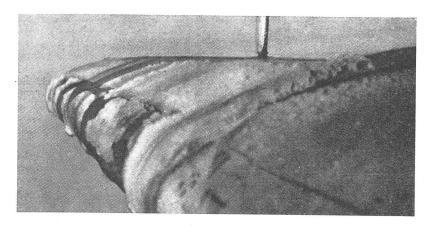
Bild 6 (links): Teil eines stark vereisten Flügels mit Gummischlauch-Vorderkante.
