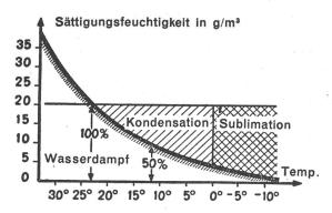
Bild 2: Temperaturkurve der Sättigungsfeuchtigkeit. Mit sinkender Temperatur nimmt die Sättigungsfeuchtigkeit (in g/m³) ab. Die bei der Abkühlung durch Kondensation und Sublimation ausscheidbare Menge an Wasserdampf ist (für eine absolute Feuchtigkeit in 20 g/m³) gegeben durch die Höhe der schraffierten Flächen.
