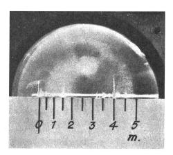
Bild 4: Sonar-Schirmbild. Bei 0 Abgang des Schallimpulses, bei 4,1 Meter Reflex an der gegenüberliegenden Zimmerwand. Kleine Schallreflexe an den in Bild 2 sichtbaren Gegenständen.
