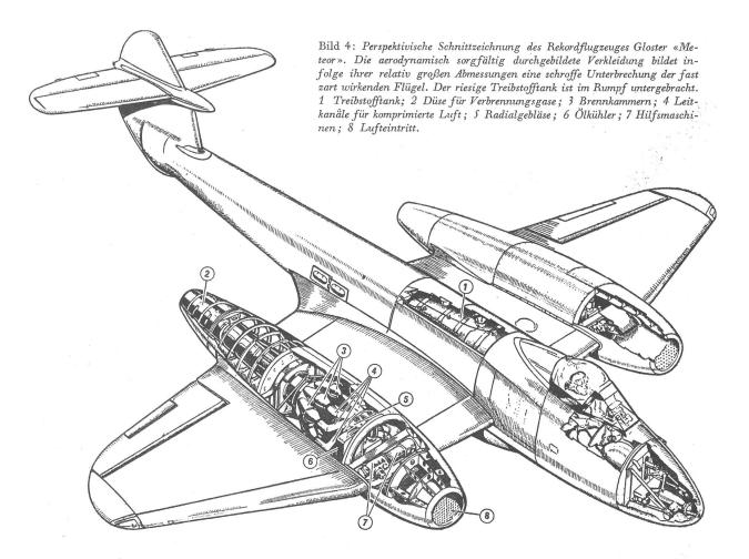
gen. Sie werden durch einen Elektromotor angeworfen und können, sobald der Druck in den Zuleitungen zu den Brennkammern etwa zwei Atmosphären erreicht hat, voll belastet werden.
