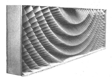
keit, wenn sie sich in einer Röhre oder zwischen Metallplatten fortpflanzen. Man wußte, daß die Umformung und die Richtung der Wellenfront durch die Festlegung der Größe und der Umrisse der Platten und deren Entfernung voneinander, unter Berücksichtigung der jeweiligen Wellenlänge, genau geregelt werden konnten.
