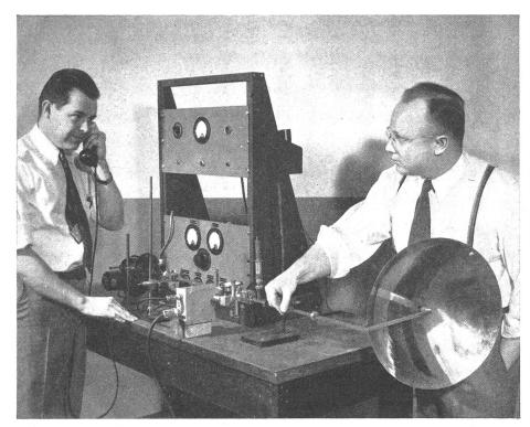
Bild 1: Die für Fernsprechen über die kleinste jemals für diesen Zweck verwendete Ultrakurzwelle -13,7 Millimeter – benutzte Versuchsanordnung. Man erkennt den Wellenleiter, eine hohle Metallröhre mit rechteckigem Querschnitt. An ihrem linken Ende ist eine metallische Radioröhre, die senden und empfangen kann. Am anderen Ende, rechts, endet sie vor einem Paraboloid-Reflektor. Das Bild zeigt somit beide Vorgänger der modernen Radiolinse.
