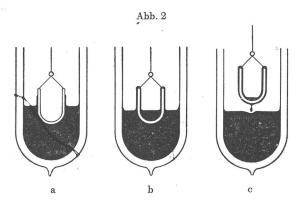
zubewahren, selbst wenn man durch genügend tiefe Temperaturen dafür sorgt, daß es nicht verdampfen kann, sondern es wird sich immer auf dem tiefstmöglichen Punkt sammeln, auch wenn es dazu mit Hilfe eines Films (nach seinem Entdecker Rollinfilm genannt), d. h. einer ganz dünnen Schicht, die die Gefäßwände überzieht, über die Gefäßwände hinwegklettern muß. Ist die Temperatur überall
