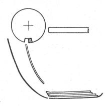
c) Die Sendung ist beendet; das Papierblatt wird ausgeworfen, diese Trommel und die Abtastvorrichtung kehren in die Ausgangslage zurück.
