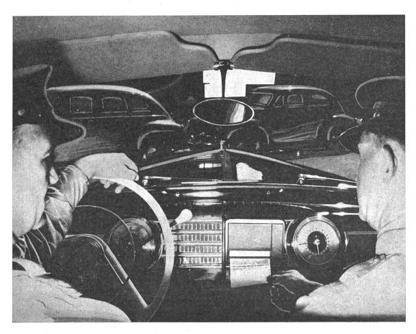
gen schriftlich zu bestätigen oder Kartenskizzen und andere Zeichnungen rasch zu übermitteln. Die Originalbotschaft wird mit der Hand oder der Schreibmaschine auf ein etwa zehn Zentimeter breites Papierband geschrieben und in den Schlitz des Sendegeräts gesteckt. Automatisch tritt im fahrenden Wagen oder Flugzeug der Facsimileempfänger in Funktion, und vor den Augen des Piloten entsteht eine um die Hälfte vergrößerte Kopie des Originals, die auf zwei Meter Entfernung gut lesbar ist (Bild 2).
