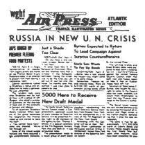
Bild 5: Die «Zeitung aus der Luft», wie sie vom Sender WGHF in New York regelmäßig ausgestrahlt wird und mit Hilfe von Facsimile-Empfangsgeräten in jedem Hause der Großstadt und Umgebung empfangen werden kann. Auch Halbtonbilder, wie Photographien, werden in der Qualität von Zeitungsreproduktionen wiedergegeben.
