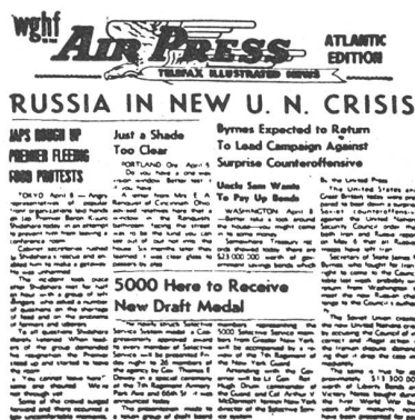
Bild 5: Die «Zeitung aus der Luft», wie sie vom Sender WGHI in New York regelmäßig ausgestrahlt wird und mit Hilfe von Facsimile-Empfangsgeräten in jedem Hause der Großstadt und Umgebung empfangen werden kann. Auch Halbtönebilder, wie Photographien, werden in der Qualität von Zeitungsreproduktionen wiedergegeben.
