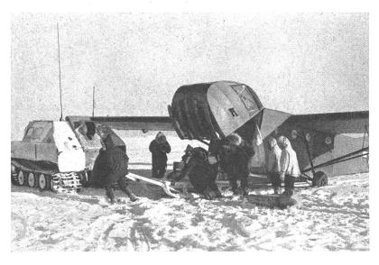
Für den Nachschub wurden auch Segelflugzeuge im Schlepp eingesetzt. Wir sehen auf dem Bilde ein Segelflugzeug, das die Expedition unterwegs erreicht hat. Soeben wird ein kompletter Motor ausgeladen, der einen unbrauchbar gewordenen in einem Schneeauto ersetzen soll.
