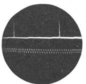
Bild 7: Zwei Hochfrequenz-Impulse, darunter Zeitmessung mit 500 Schw./Sek.
