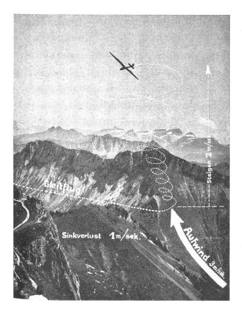
Bild 3 links: Segelflug ist langsames Abwärtsgleiten in schnell hochsteigenden Luftmassen. Hier fand ein auf dem Rochers de Naye-Gipfel gestarteter Segler ein «Thermikkamin», das mit drei Meter pro Sekunde «zog». Sofort begann der Pilot, dessen Maschine pro Sekunde je ein Meter Flughöhe verliert, im Aufwindstrom zu kreisen, so daß er mit zwei Meter pro Sekunde Steiggeschwindigkeit den Gipfelstartplatz um mehr als 1500 Meter überhöhen konnte.
