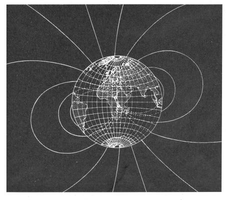
Bild 2 oben: Isoklinenkarte des Erdmagnetimnus. Die Isoklinen bilden um den magnetischen Nordpol geschlossene Kurven, eine Art magnetischer Breitenkreise.
