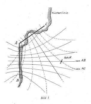
Der amtlichen Literatur entnehmen wir einige maßgebende Daten: So wird die maximale Reichweite der «Loran»-Stationen bei Tage durchschnittlich zu rund 1400 Kilometern, bei Nacht aber zu 2600 Kilometern (die verwendete Wellenlänge zu  $\lambda=154$  Metern – Frequenz N=195 Kilohertz –, die Impulsdauer zu 80 Mikrosekunden) angegeben, so daß pro Impuls ungefähr 16 Wellen ausgestrahlt werden. Dieses durch viele der ganzen englischen Küste entlang aufgestellte Sendeanlagen verwirk-
