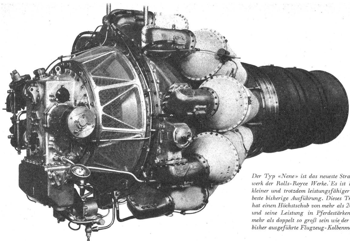
Der Typ «Nene» ist das neueste Strahltriebwerk der Rolls-Royce Werke. Es ist leichter, kleiner und trotzdem leistungsfähiger als die beste bisherige Ausführung. Dieses Triebwerk hat einen Höchstschnell von mehr als 2000 kg, und seine Leistung in Pferdestärken dürfte mehr als doppelt so groß sein wie der stärkste bisher ausgeführte Flugzeug-Kolbenmotor.
