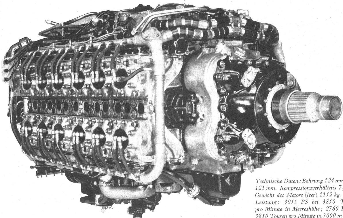
Technische Daten: Bohrung 124 mm, Hub 121 mm. Kompressionsverhältnis 7,0 : 1. Gewicht des Motors (leer) 1152 kg. Leistung: 3055 PS bei 3850 Touren pro Minute in Meereshöhe; 2760 PS bei 3850 Touren pro Minute in 3000 m Höhe, Höchstleistung für Start und Steigen (mit Wassereinspritzung) 3000 PS.
