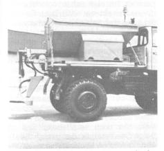
Zapfwellenantrieb. Die Streugutförderung erfolgt über ein wartungsfreies Gummiförderband mit V-Profil, was die Unfallgefahr vermindert und die Reinigung vereinfacht. Alle Funktionen der grossen Nido-Streuer können von der Kabine aus elektrisch ferngesteuert werden. Nido-Streuer eignen sich zum Streuen von Salz, Splitt, Sand, Kalzium sowie Misch- und Feuchtsalz.
