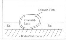
Eindringen des Granulatkornes in die Eisfläche durch den Salzsole-Film.
