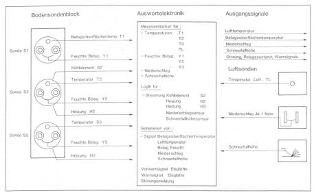
Abb. 8. Aufbau einer Messstelle als Blockschema.
