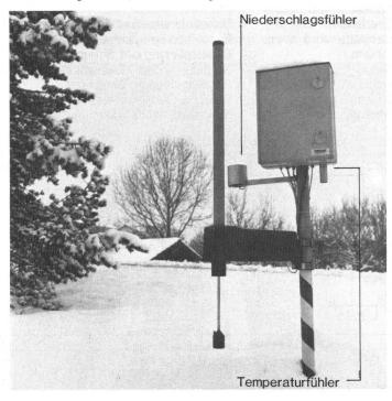
Abb. 7. Auswertelektronik mit Luftsonden und Schneehöhenmesser.
