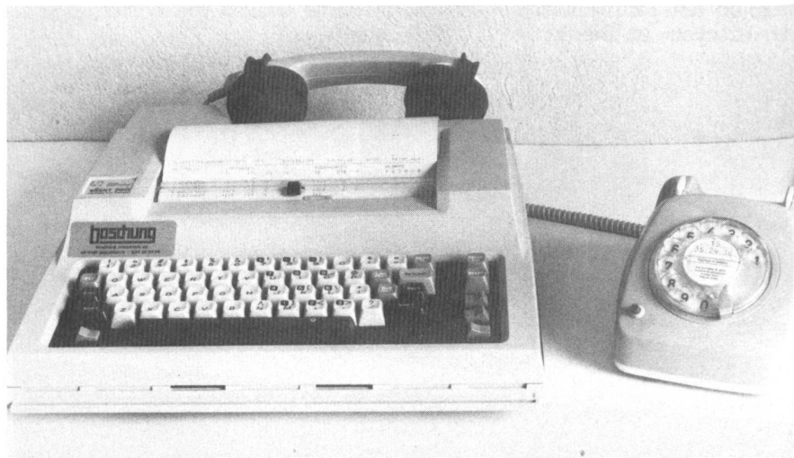
Abb. 11. Datenterminal mit Akustikkoppler für Datenübermittlung durchs Telefon.
