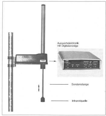
Abb. 3. Salzmengenmessgerät.
