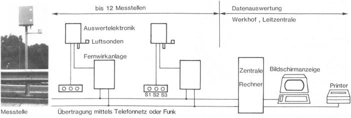
Abb. 5. Glatteisfrühwarnsystem (Funktionsübersicht).
