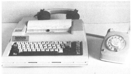
Abb. 11. Datenterminal mit Akustikkoppler für Datenübermittlung durchs Telefon.
