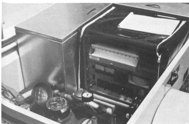
Rauhigkeitsmessung in einem abgeschieberten Netzsektor.
