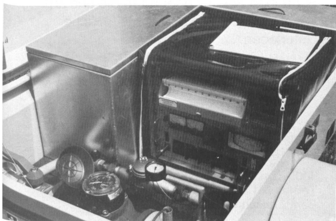
Rauhigkeitsmessung in einem abgeschieberten Netzsektor.
