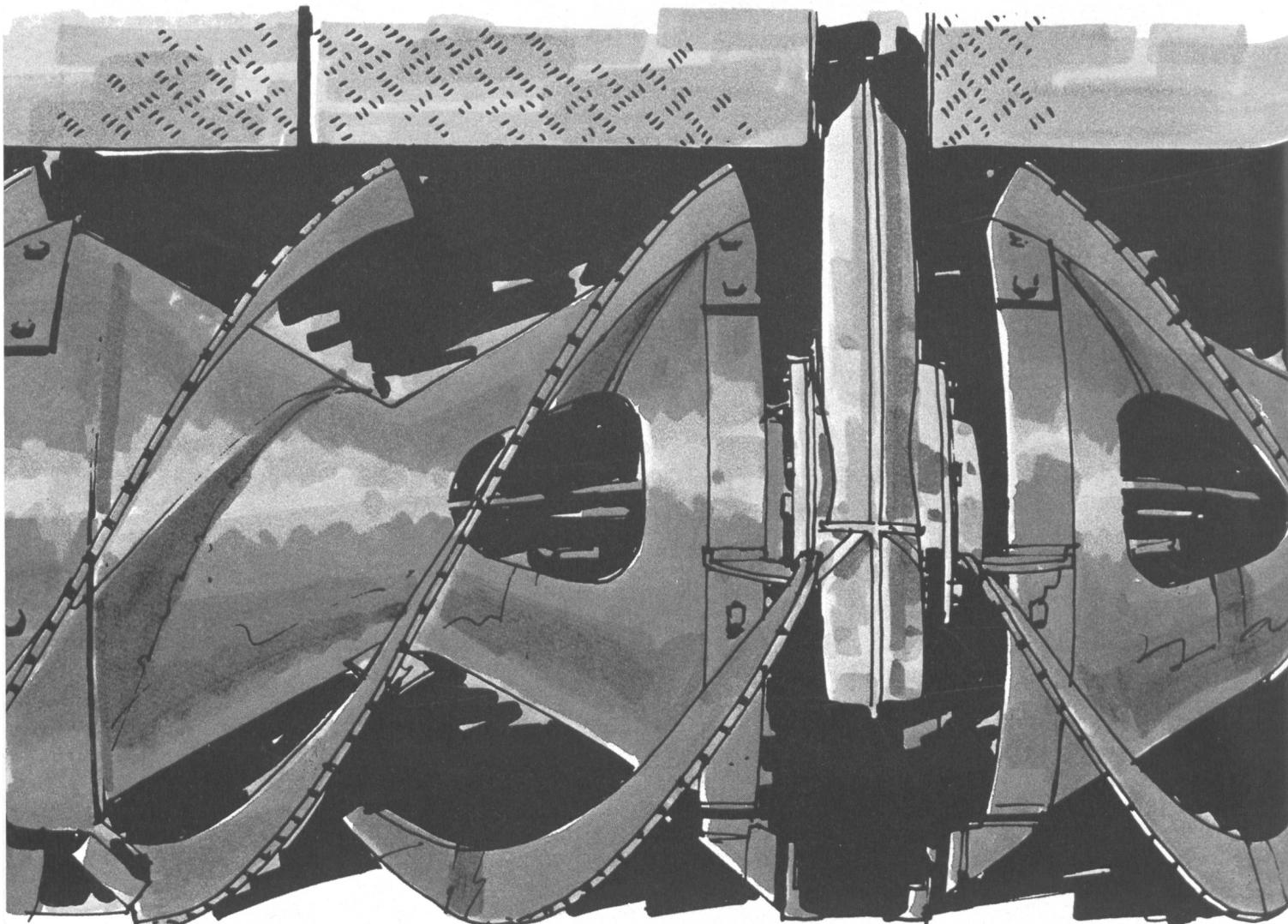
**Dieses Aggregat fräst sich durch jede Schneeart. Dank dem bewährten Rolba-Frässchleuder-Prinzip schleudert es den Schnee via Auswurfkamin ins Gelände oder präzis auf Lastwagen.**
