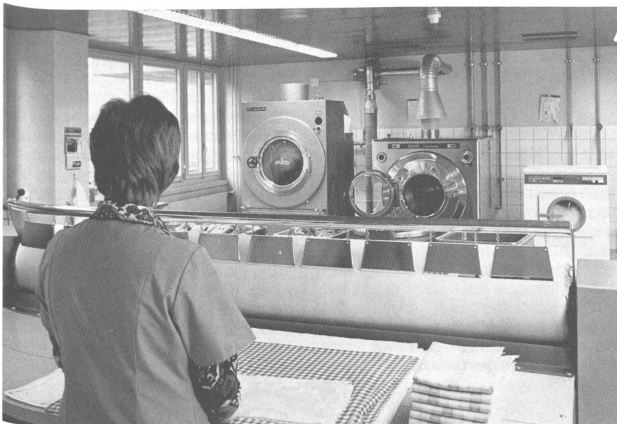
Hohe Umstellkosten bei gewerblichen Gasanwendungen: Wäscherei mit Gasmange (vorn), Gaswaschmaschine und Gastumbler.
