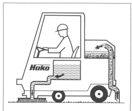
Die kontrarotierenden Bürstenaggregate reinigen unter Laugenzufuhr Bodenflächen intensiv und gründlich. Im gleichen Arbeitsgang wird die Schmutzlauge durch starke Sauggebläse aufgenommen. Der Boden ist sofort trocken und wieder begehbar.
