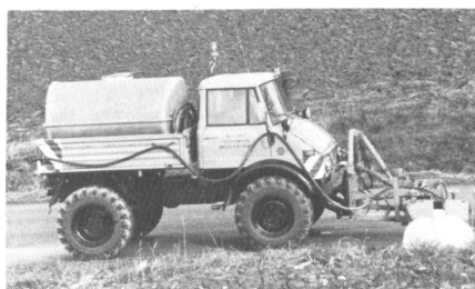
Unimog U-900 mit Front-Waschbürste zum Reinigen von Signalpfosten. Das Wasser wird auf der Brücke des Unimog mitgeführt.
