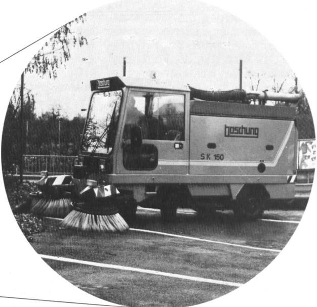
Hydrostatischer Fahrantrieb, stufenlos, 0 bis 25 km/h. Schmutzbehälterinhalt 1500 l, Wassertank 470 l. Pat. Wasserumlaufsystem (mehrmalige Verwendung des Wassers). Panoramakabine, robustes 4-Rad-Chassis mit Frontlenkung. Grosse Flächenleistung und hohe Saugleistung (pat. Saugmund). Variable Arbeitsbreite von 1,5 m bis maximal 2,2 m.
