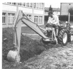
Arbeiten mit dem voll-hydraulischen Heckbagger
