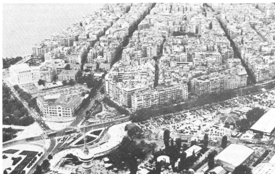
Abb. 4a. Das Zentrum von Thessaloniki ist gekennzeichnet durch geschlossene Bauweise und eine sehr hohe Ausnutzungsziffer. Folgen davon sind mangelhafte Belichtung und Belüftung der Wohnungen sowie übermässige Lärmentwicklung in den schluchtartigen Strassenzügen.
