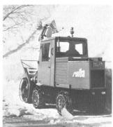
Die Rolba-Frässchleuder ist, wie der Name sagt, eine Schneefräse, das heisst der Schnee wird mittels schraubenlinienförmigen Fräsmessern abgefräst und einem Schleuderaggregat zugeführt, von wo der Schnee in einem kompakten Strahl aus dem Aggregat gefördert wird.
