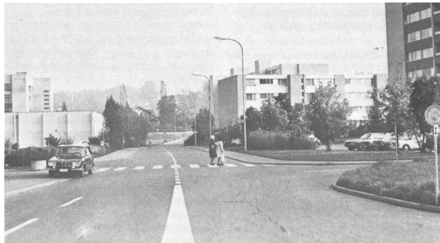
Abb. 3. Die Energieverschwendung in anderer Form: Die Überdimensionierung von Fahrbahnen.
