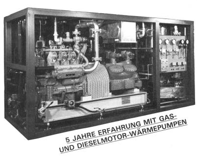
Gas- und Dieselmotor-Wärmepumpen mit Leistungen von 120 bis 500 kW
