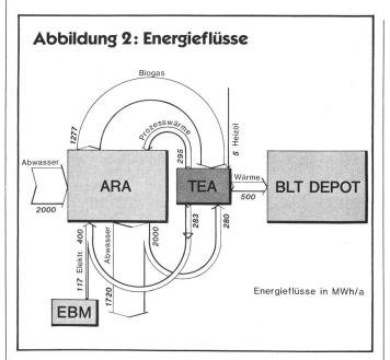
res den Wärmebedarf der Kläranlage für Prozesswärme sowie Raumheizung und versorgt das BLT-Depot mit der nötigen Wärme für die Heizung des Verwaltungstraktes und der Serviceräume sowie für Warmwasser. Durch die Wärmeentnahme aus dem Abwasser wird zudem die Wasserqualität des Marchbaches verbessert, in den das gereinigte Abwasser fliesst.
