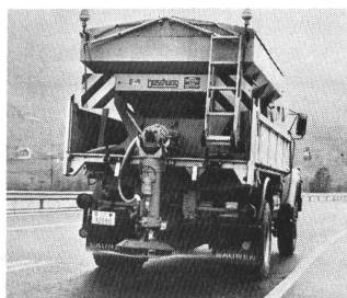
Aufsatzstreuautomat mit Mischsalzeinrichtung und Klappverdeck im Autobahneinsatz.
