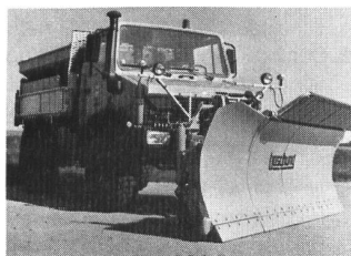
Mehrscharen-Federschneepflug mit Windleitschirm und Aufsatzstreuautomat auf Unimog 1700.
