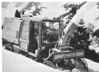
Spezialschneefräse Schmidt-Boschung, Typ FV-PF. Hydrostatischer Antrieb. Räumbreite wahlweise 1,4 oder 1,6 m. Durchmesser der Frästrommel 0,8 m. Höhe des Fräsvorbaus 1,1 m. Drehzahl der Frästrommel stufenlos verstellbar. Wurfweite etwa 15 m.
