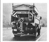
Aufsatzstreuautomat mit Mischsalzeinrichtung und Klappverdeck im Autobahneinsatz.
