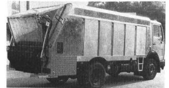
Spezial-Reinigungsfahrzeug Contena clean für die effiziente Reinigung und Desinfektion aller Abfall-container.
