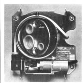
Innenleben des Temset-Fortluftautomaten: 1 Kunststoffstopfen (zur Vergrösserung des Grundvolumenstromes). 2 Messnippelanschluss. 3 Halterungslasche für Haube. 4 Anschlusskabel. 5 Elektrothermischer Antrieb. 6 Gerätesteckverbindung.
