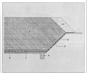
Abb. 4. Etappe 2b der Abdichtung. Diese besteht aus einer Kunststoff-Dichtungsbahn Sarnafil P, 2 mm stark, aus Niederdruckpolyäthylen mit hoher Dichte (HDPE), schwarz durchgefärbt. Als Schutz gegen Beschädigung durch Durchschlagen ist die KDB zwischen je zwei Lagen von 10 cm Sand eingepackt. Auf der Böschung dient ein Geotextil (Typ Bidim) als Schutzlage, auf der Oberseite darf als erste Lage nur Hausmüll oder Klärschlamm gelagert werden.
